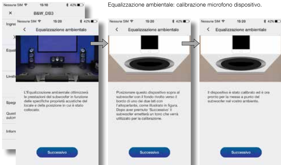
Equalizzazione ambientale: calibrazione microfono dispositivo.
