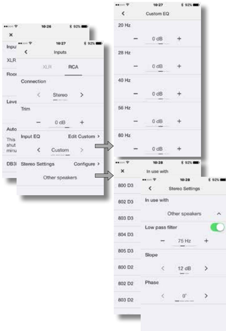
Stereo-instellingen: low-pass filterselectie of configuratie.
